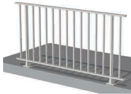
Barreaudage sous main courante
