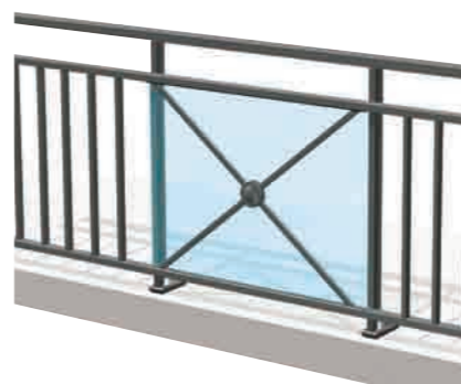
Bande filante sous lisse avec barreaudage et croix de Saint-André
